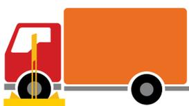
Travamento das rodas com o equipamento adequado.
